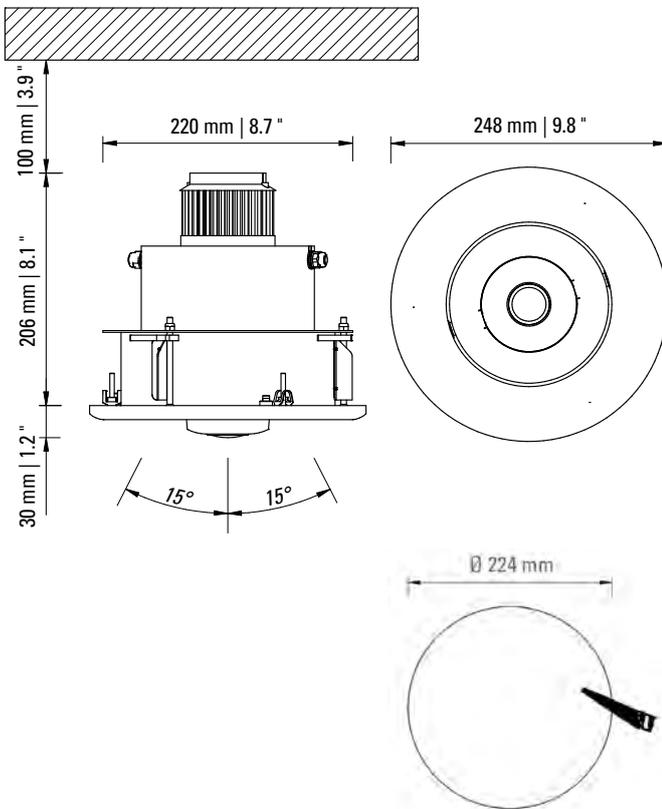
40Wの高出力LEDを搭載したPHOS45ダウンライトは、騒音に対応したファンで冷却し、その力を十分に発揮します。乾燥した室内使用に適しており、目立たないよう天井に設置することが可能です。商品売り場や、ホール、展示会、博物館での使用が適しています。付属の電子バラストは埋め込み型です。投影モチーフ（ゴボ）は工具を使用せずに交換できます。
