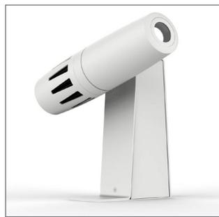
40Wの高出力LEDを搭載したPHOS45 outdoorは、ノイズ対策を施したファンによって冷却され、パワーも優れたプロジェクターです。耐水性に優れた接続チューブを使用しており、年間を通しての屋外使用や、湿気の多い室内での使用に適しています。特に、建物や歩道での歩行者用メッセージ(直径4mまでの範囲)などで使用されることが多いでしょう。投影モチーフ(ゴボ)は工具を使わずに交換可能です。
